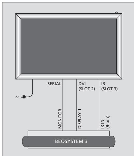
**Δέκτης IR:** Η οθόνη διαθέτει ενσωματωμένο δέκτη IR. Γι' αυτό, δεν χρειάζεται να τοποθετήσετε έναν έχωριστο δέκτη, όπως περιγράφεται στο Βιβλίο Αναφοράς του BeoSystem. Μόνο εάν η οθόνη του βιντεοπροβολέα καλύπτει τον ενσωματωμένο δέκτη IR κατά τη χρήση, πρέπει να τοποθετήσετε ένα δεύτερο δέκτη IR και να τον συνδέσετε στην δεύτερη υποδοχή IR-IN στο σύστημά σας.
